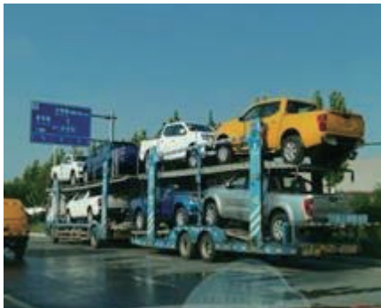
合規中置軸車輛裝載商品車
