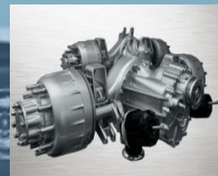
东风高速轮减桥 东风14档变速箱
